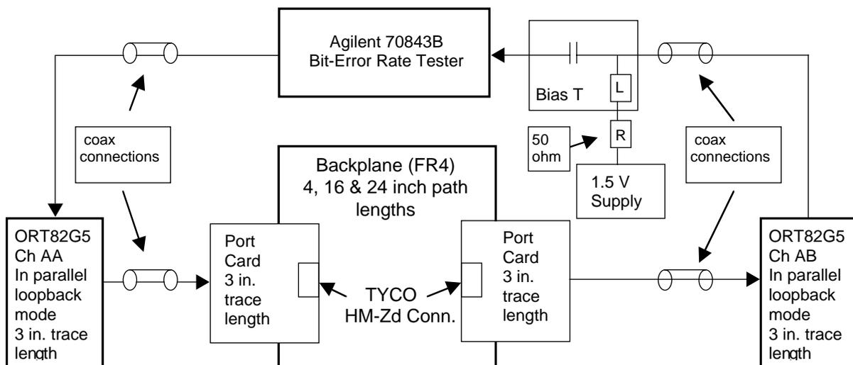
**Test Setup Parameters**
